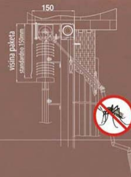
Žaluzina sa komarnikom (vanjsku žaluzinu možemo izvesti sa komarnikom koji se ugradi pod žaluzinu. sa time se dubina ugrađene žaluzine povećava na 150mm)
